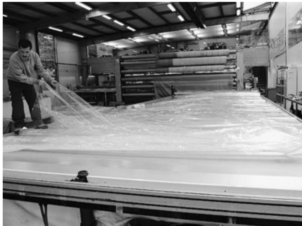
Ein Blick in die Produktion in der neuen Halle der Firma Vector Foiltec, die Folien für die Dachbedeckung herstellt. FOTO: SYLVIA WÖRMKE
